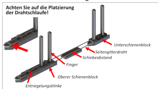
Oberer seitlicher Schienenblock und Kabelbaugruppe
