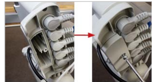
Anbringen der Batterieabdeckung – Die Batterieabdeckung mit der mitgelieferten Schraube abschrauben bzw. festschrauben.
