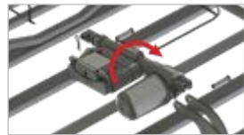
Drehung des Rückenlehnenaktuators
