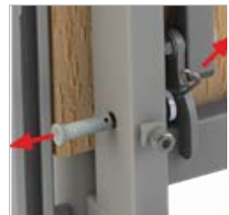
Ausbau von Gabelkopfbolzen, Distanzstück und R-Clip
