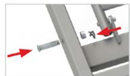
Gabelkopfbolzen, Distanzstück und R-Clip-Anschluss
